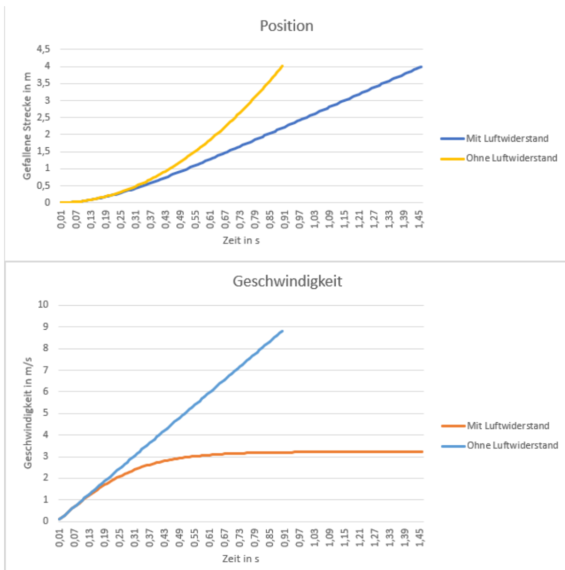
Abbildung 23: Position und Geschwindigkeit mit und ohne Luftwiderstand
