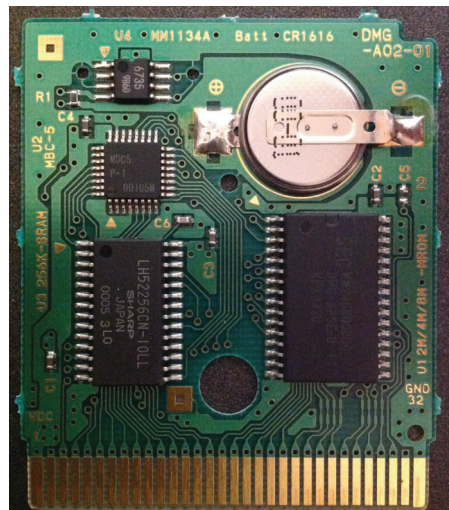
Abbildung 3: Eine Cartridge mit dem MBC5, hier Pokémon Gelb.
