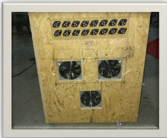
Bild 4): Rückseite des Gestells mit Lüftung und Sicherungen
