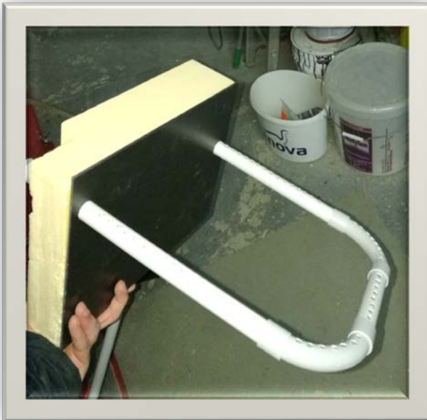
Bild 5): Isopropanollauf mit Löchern
